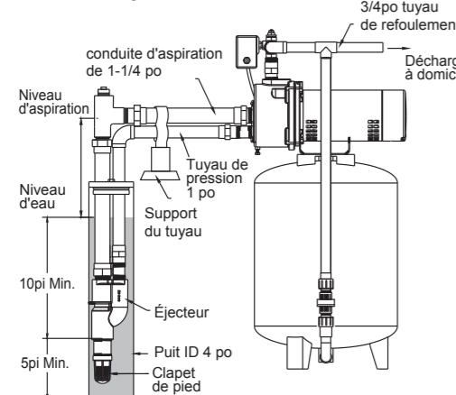
Pour un puits profond, l'éjecteur doit être remplacé par les pièces suivantes.
